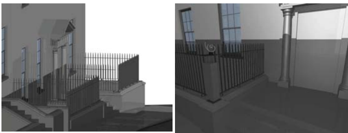
Figure 14. Mapping Parametric Objects to Survey Data.
