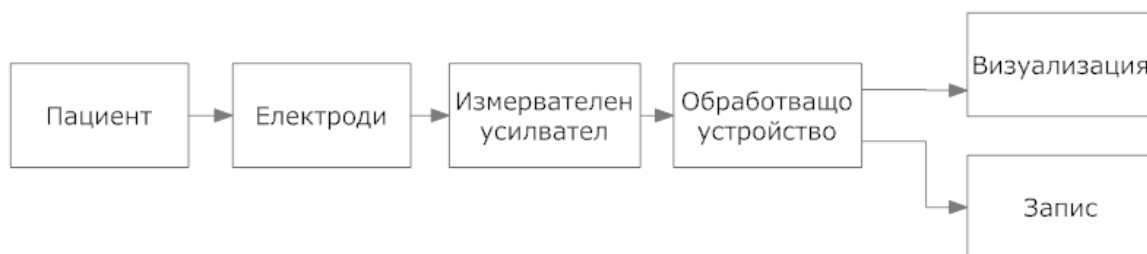
Фиг. 2.6. Обща блокова схема на апарат за измерване на биопотенциали
