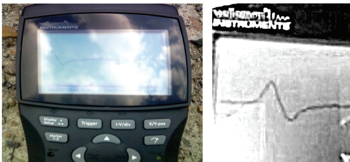
Фиг.3.5. Пик при преминаване на автомобил, наблюдаван на екрана на използвания мобилен осцилоскоп (Velleman HPS10)
