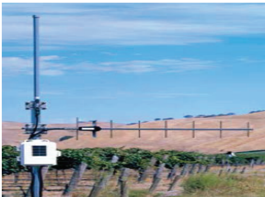
Фиг. 3.24. Конзола с метеорологична станция и антена [116]
