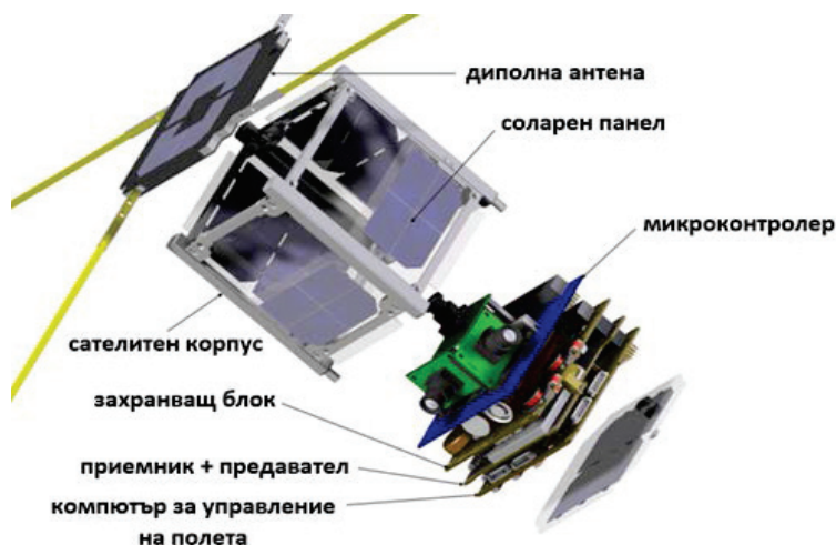
Фиг. 3.29. Опростена комерсиална структура на наносателит [72].
